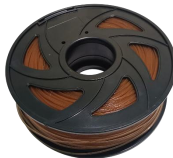
Figura 2. Filamento de PLA-Cebada obtenido.
