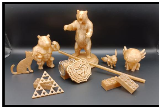
Figura 6. Diversas impresiones realizadas mediante el filamento de PLA-Cebada.
